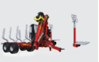
La passerelle de l'opérateur assure la sécurité et la bonne visibilité de la manutention de la grue forestière hydraulique pendant le chargement de la remorque.
