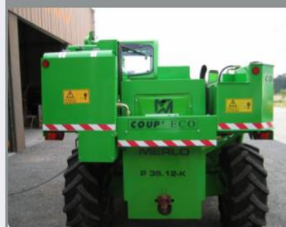
Centrale hydraulique indépendante
