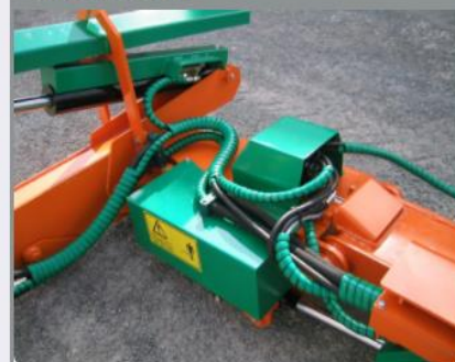
Bloc hydraulique des mouvements intégré dans le bras
