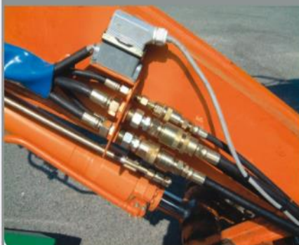
Connectique hydraulique et électrique avec la pelleuse
