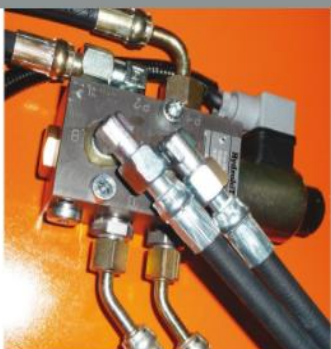
Sélecteur de fonction pour les 2 vérins d'orientation
